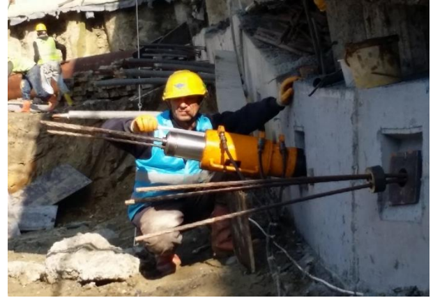
Resim 1A.10. Ankraj germe testi
